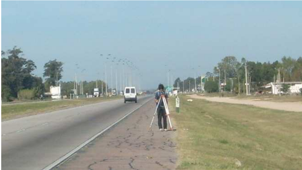
Fig. 26: Procedimiento en campo para la determinación de desniveles.
