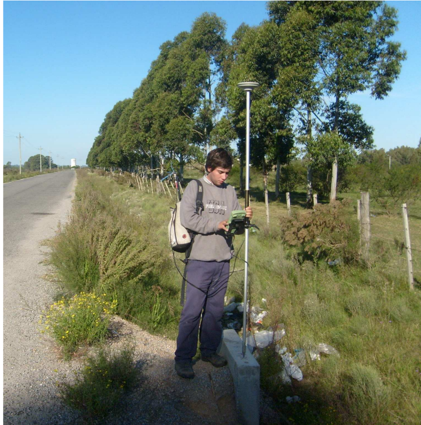
Fig. 30: Relevamiento con GPS-Leica 1230.
